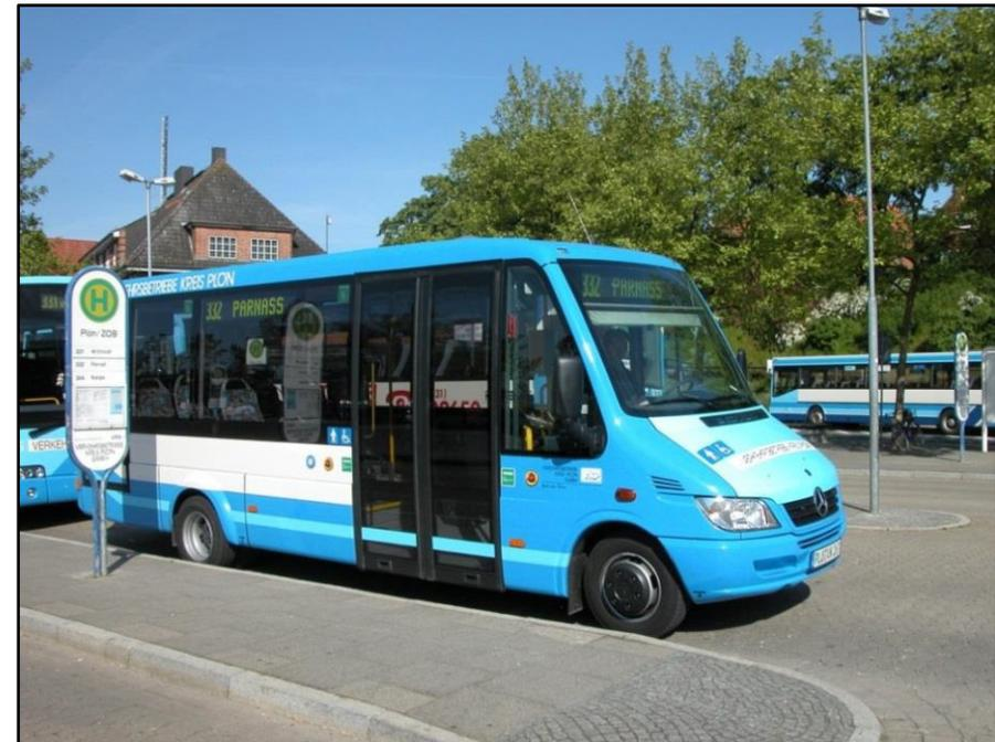
Abb. 8/9: Barrierefreiheit auch bei Kleinfahrzeugen: Niederflur-Kleinbus der VKP außen.....
