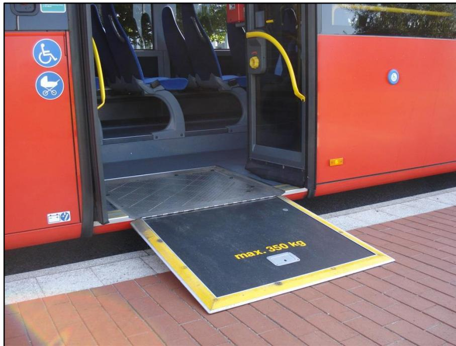
Abb.: 15: Ausgeklappte Rampe am abgesenkten Bus
