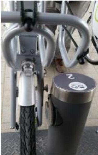
**Abbildung 12: Ladetechnik über Vorderradgabel**
